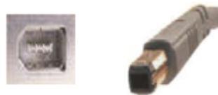
Hình 1.14: Cổng và đầu nối FireWire
